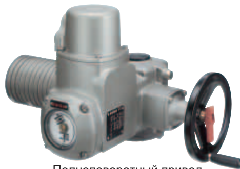
Полноповоротный привод SA 07.1 – SA 16.1 / SA 25.1 – SA 48.1 крутящий момент от 10 до 32000 Нм Число оборотов от 4 до 180 в мин.
